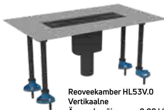
Reoveekamber HL53Prblue.0 Konstruktsiooni kõrgus 90 mm Äravoolu võimsus = 0,55 l/s
